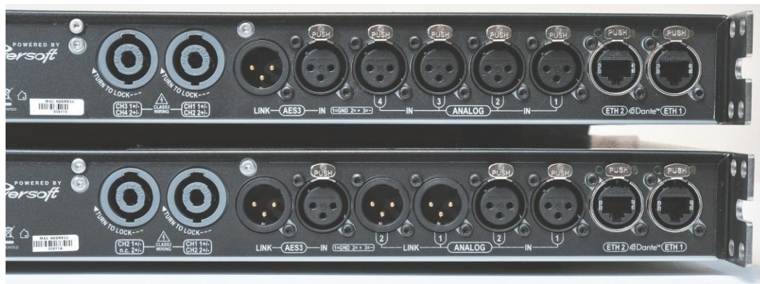
Steckerbeschriftung je nach Modell als vier einzelne Kanäle oder zwei Kanäle plus Link
