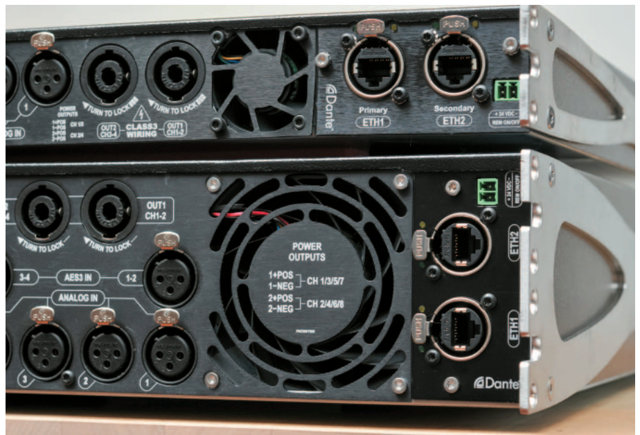
Netzwerkbuchsen für den primären und sekundären Anschluss des Dante-Netzwerks. Oben die X4 und unten die X8
